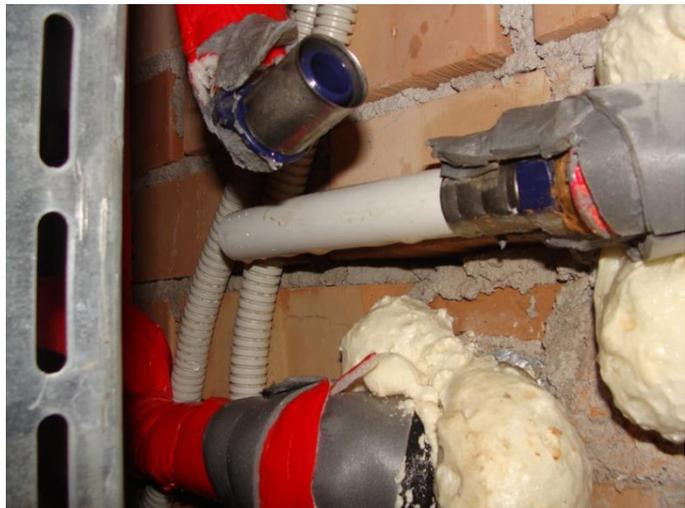
Abb. 2: bei dynamischer Druckprüfung ausgeschobene unverpresste Verbindung
